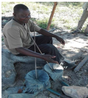
Figura 3. Fole de forja (ou muyeveyo).
