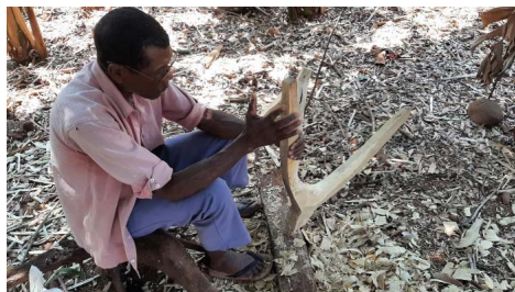
Figura 7. Sr. José, fazendo a Cangaia, utilizando a medida tradicional do palmo.
