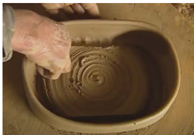
Figura 12. Processo de construção de uma assadeira de base, aproximadamente, retangular.
