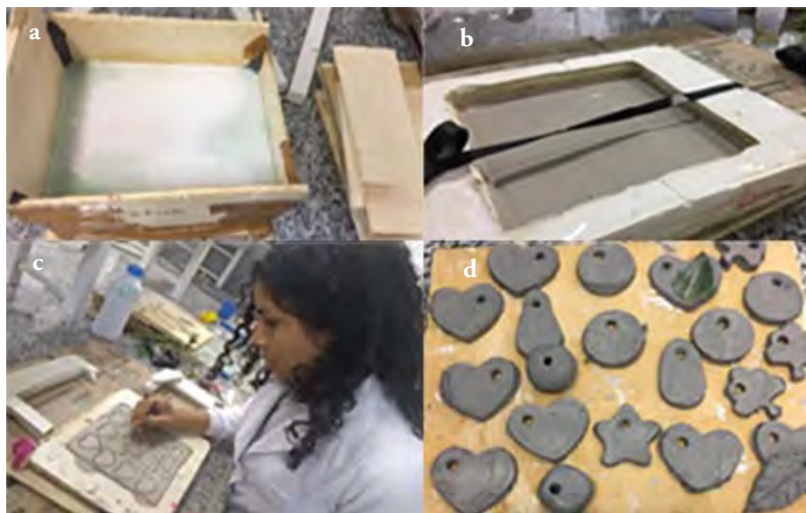
Figura 5. Processo inicial da fabricação das peças. a) Fabricação dos moldes de gesso. b) Colagem de barbotina no molde de gesso. c) Cortes e desenhos de peças cerâmicas d) Peças prontas para queima.
